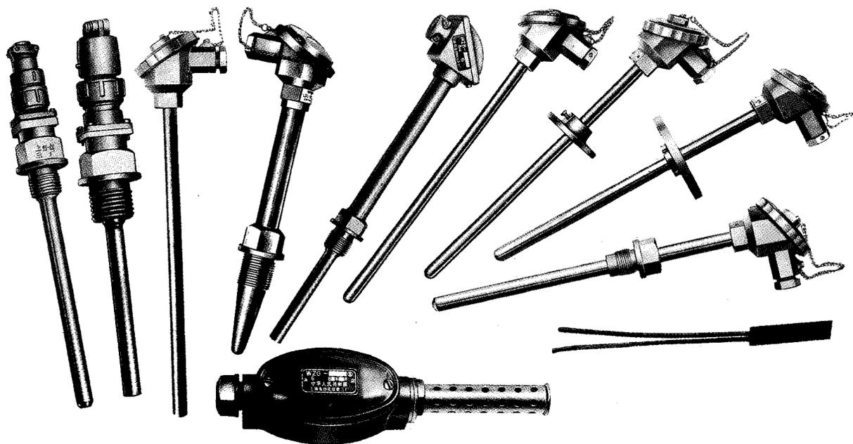
工业用热电阻作为测量温度的传感器，通常和显示仪表、记录仪表和电子调节器配套使用。它可以直接测量各种生产过程中从 $-200^{\circ}\text{C}$ 至 $420^{\circ}\text{C}$ 范围内的液体、蒸汽和气体介质以及固体表面温度。
