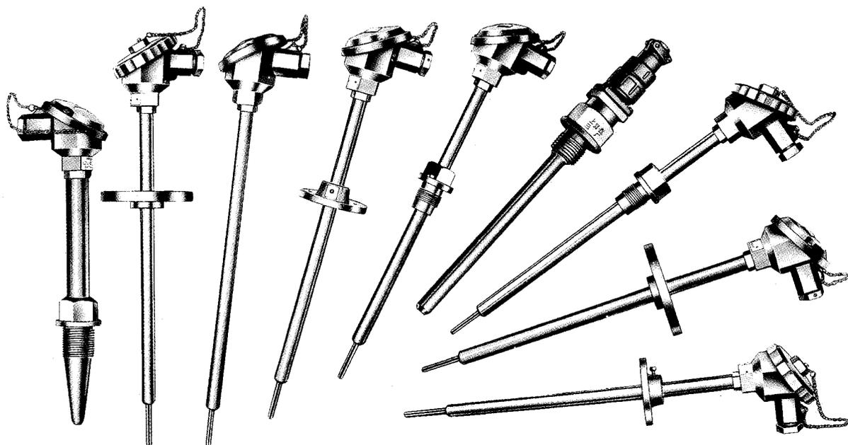
工业用铂电阻作为温度测量变送器,通常用来和显示、记录、调节仪表配套,直接测量各种生产过程中从  $-200\sim 500^{\circ}\text{C}$  范围内的液体、蒸气和气体介质以及固体等表面温度。
