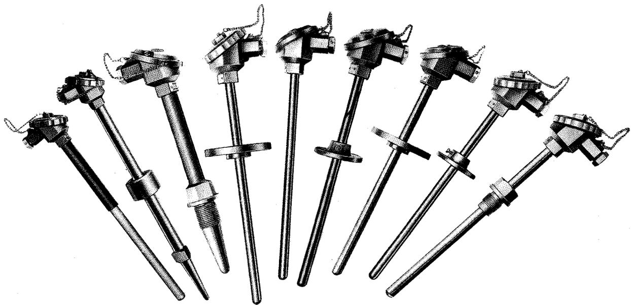
工业用装配式热电偶作为测量温度的传感器,通常和显示仪表、记录仪表和电子调节器配套使用。它可以直接测量各种生产过程中从 $0^{\circ}\text{C}\sim 1800^{\circ}\text{C}$ 范围内的液体、蒸汽和气体介质以及固体的表面温度。
